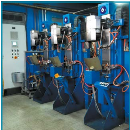
Современные автоматические сварочные и клеящие машины используются для соединения стеклянных деталей друг с другом.
