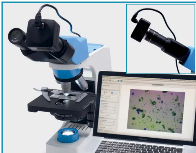
Оснащен вращающейся на 360° бинокулярной насадкой, наклоненной на 30°, с регулируемым расстоянием между центрами окуляров в диапазоне 50 мм - 75 мм.
