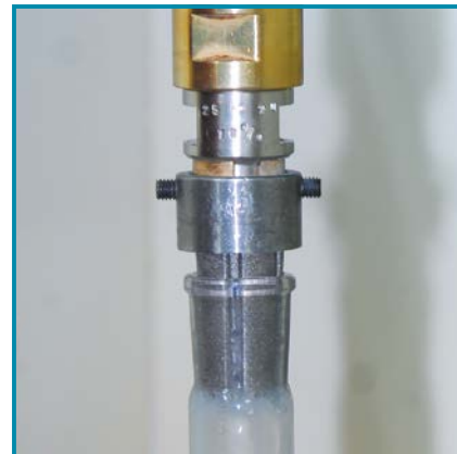
Шлифование выполняется алмазными развертками, гарантирующими оптимальные результаты и высочайшую точность.
