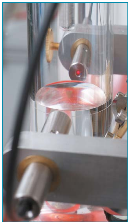
Мениск автоматически определяется лазерным лучом точно в крайней нижней точке.
