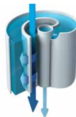
Рисунок 1. Сквозной вид ОО мембраны системы RiOs™ Essential, вставленной в картридж. Тангенциальное направление потока снижает риск засорения мембраны; мембрана удаляет 95-99% неорганических и 99% всех растворенных органических веществ молекулярным весом более 200 Дальтон, таких как микроорганизмы и частицы.
